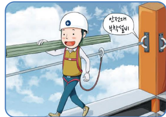
6 안전대 착용 시 안전대 부착설비 설치
