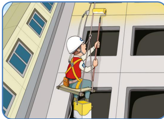
5 달비계 작업 시 안전대 및 구명줄 설치
